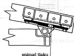
2. Umístění snímače tlaku u listových per – Position of a pressure sensing unit at leaf springs (snímač tlaku – pressure sensing units)
