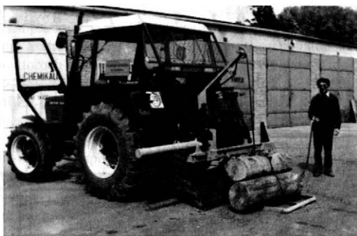
4. Guliače na vyklápacích ramenách – Round billets on the movable arms
