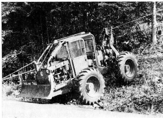
1. Speciální lesní kolový traktor LKT 81 se zabezpečovacím zařízením a automaticky řízeným pojezdem při jízdě kolmo na vrstevnice terénu v pracovním postavení — The LKT 81 special forest wheel tractor with security device and automatically controlled drive for moving perpendicularly to the landscape's contour lines in working position
