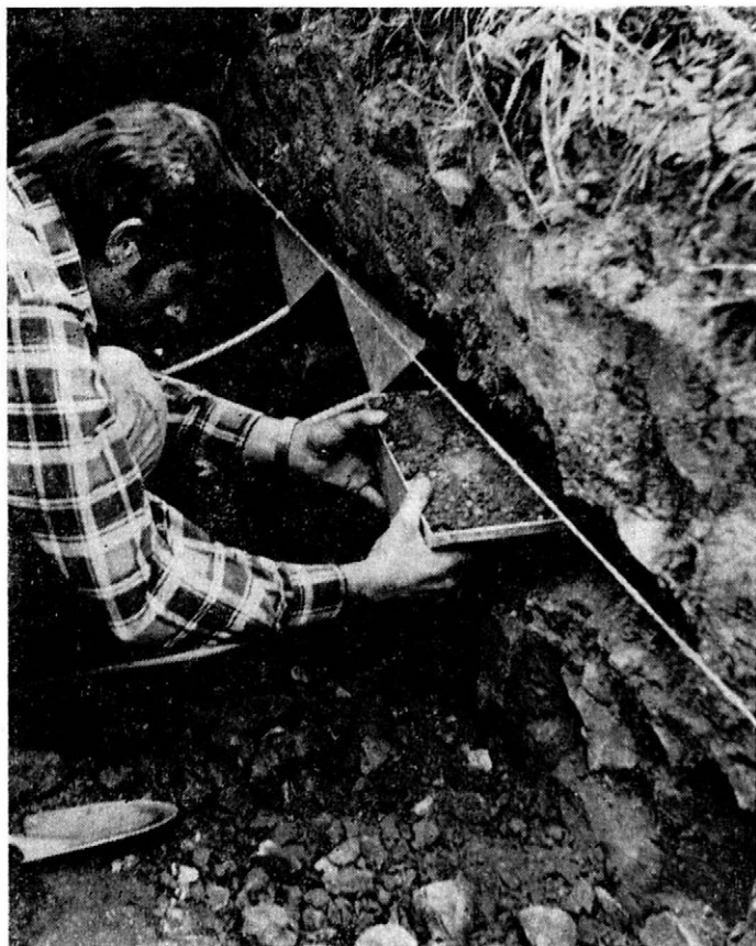
5. Lyzimetry ke sledování vertikálního odtoku z rozhraní pedosféry a podložní horniny byly dokonale utěsněny zeminou, aby spojení s půdou nebylo přerušeno — Lysimeters used to measure vertical runoff from the boundary of pedosphere and subsoil rock were tightly sealed with soil not to interrupt the connection with the surrounding soil
