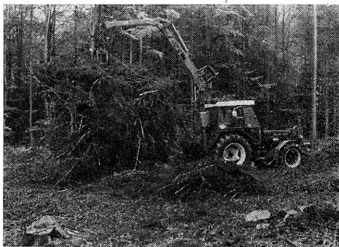
7. Nakládání klestu na vyvážecí soupravu VS-5H — Loading the loppings onto a VS-5H truck-and-tractor combination set
