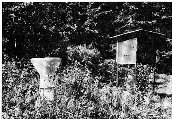
1. Ombrometr pro záchyt srážek na Javorovém u Trčince u stanice lanovky (890 m n. m.). — An ombrometer for precipitation capture at the cableway station on Javorový near Trčinec (890 m a. s. l.)
