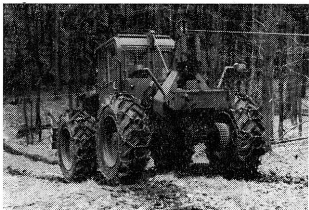
3. Vyústění zabezpečovacího lana v zadní části traktoru. — The grip of a safety rope in the rear part of the tractor
