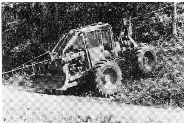
5. Celkový pohled na traktor LKT 80-ZZ se zabezpečovacím zařízením včetně čidel automatického řízení. — A general view of the LKT 80-ZZ tractor with a safety equipment, including the automatic-control sensors
