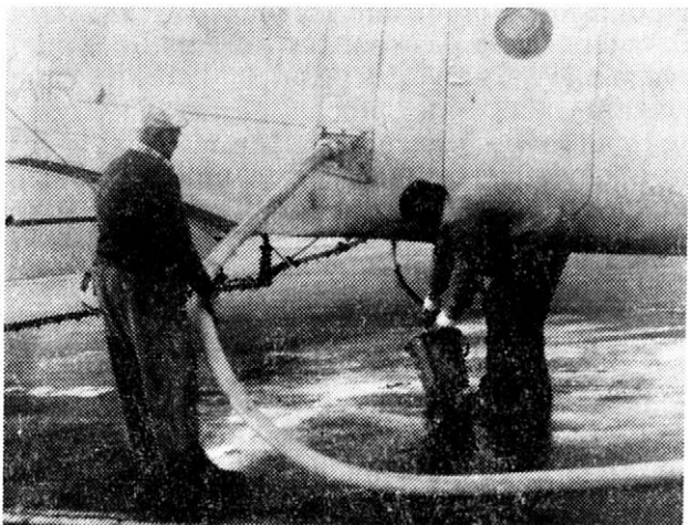
5. Plnenie aplikačnej nádrže lietadla biopreparátom (vľavo) a pridávanie subletálnej dávky stresora (vpravo). — Filling the application tank of the aircraft with a microbial preparation (left) and adding the sublethal dose of a chemical insecticide (right)
