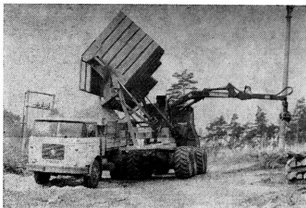
6. Sypání štěpek z kontejneru sekačky Bruks 800 CT do odvozního prostředku (LZ Bučovice). — Unloading the chips from the container of the Bruks 800 CT hogging machine into a hauling truck (Forest Farm Bučovice)
