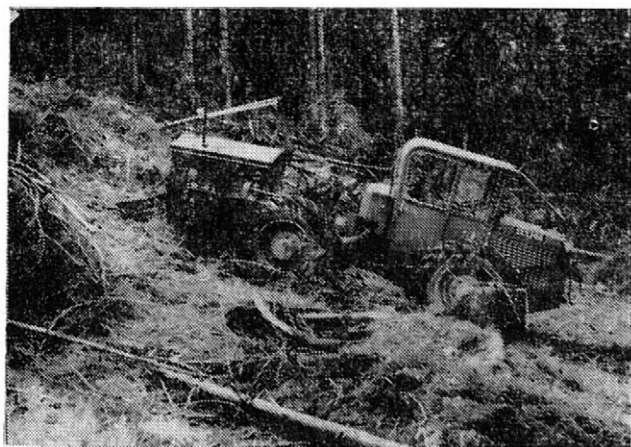
1. Instalace elektroagregátu na speciálním lesnickém traktoru. — Installation of the electric aggregate on a special forest tractor
