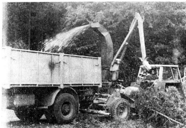
4. Funkční model sekačky VS Křtiny při sekání prořezávkového materiálu na odvozním místě. — A functional model of the hogging machine designed at the Research Station at Křtiny in the process of chipping the thinning material at the extraction place
