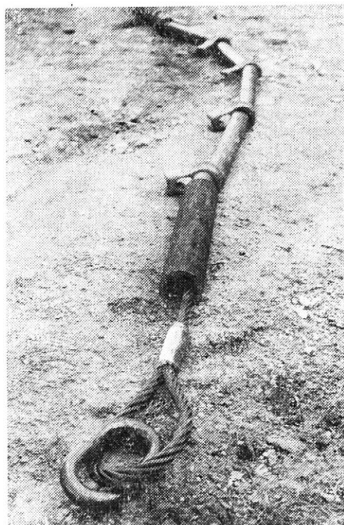
4. Sběrné lano vložené mezi konce tažného a vratného lana
