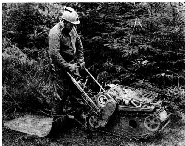
3. Přibližování svazku stromků strojem LPV-20. — Skidding of a bundle of trees by the machine LPV-20
