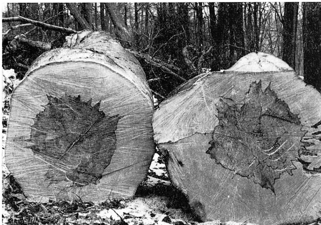
8. Zmýcený buk lesní vyhnílý v kořenech a bazální části kmene lesklokorkou pryskyřičnatou. Hniloba pronikla od kořenů kmenem do výšky 1,5 m. Nad hnilobou v kmeni bylo vytvořeno v délce 11 m výrazné červenohnědé nepravé jádro. Na jednovýškovém výřezu vpravo je pokročilá bílá hniloba dřeva a na výřezu vlevo je dřevo hnilobou narušeno jen ve střední části. Polesí Bučín, LZ Náměšť nad Oslavou. Snímek Černý, 11. 2. 1973. — Felled Fagus silvatica tree, decayed and infected with Ganoderma resinaceum in roots and stem base. The rot spread from the roots up to a height of 1.5 m. Above the rot along the stem a conspicuous untrue red-brown nucleus was formed in a length of 11 m. On a one-meter section on the right, there is a developed white rot, on the left the rot attacked the wood only in the central part. Bučín forest district, forest enterprise Náměšť nad Oslavou. Photo by Černý, February 11, 1973
