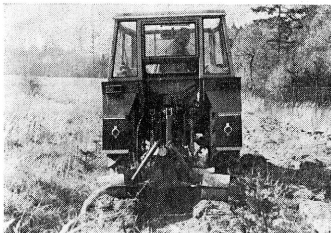
3, 4. K pruhové přípravě půdy na plochách určených k zalesnění je používán pluh Kromberger, popř. finské lesní brány na LKT. — For strip preparation of the soil on areas to be afforested the Kromberger plough is used, or the Finnish forest harrow attached to the forest wheeled tractor
