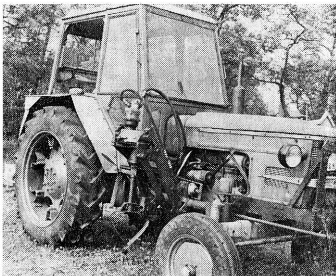
8. Pohled na jamkovací zařízení na UKT. — View of the hole digger attached to the general- -purpose wheeled tractor
