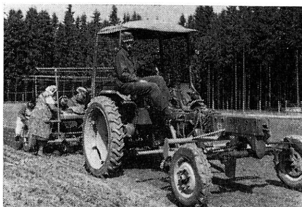
11. Strojní školkování semenáčků malotraktorem RS-09. — Machine transplanting of seedlings by small tractor RS-09
