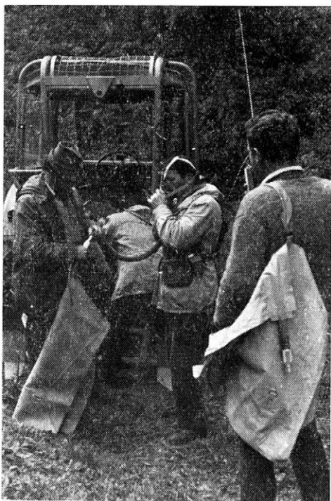
6. Telemetrická aparatura pro přenos tepové frekvence na opasku zkušebního pracovníka. — Telemetric apparatus for pulse frequency transmission, fixed on belt of test person
