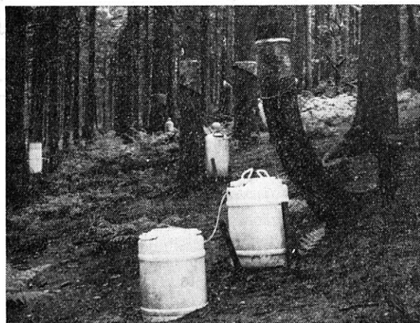
4. Zařízení k měření stoku po kmenech v horském porostu. Pokusná plocha Šerlich. Snímek Chlumský. — Equipment for stem flow measurement in a mountain forest stand. Experimental plot Šerlich. Photo by Chlumský
