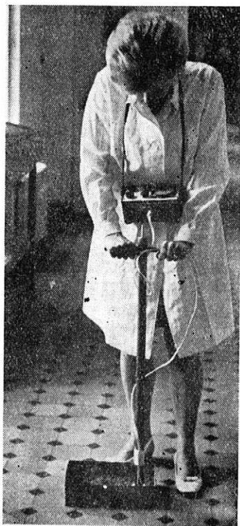
15. Postup měření impedance vzorku při kalibraci. — Soil sample impedance measuring procedure during calibration
