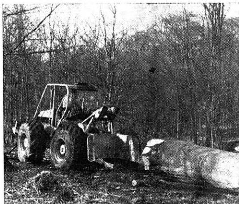
5. Okolí Dieppe (Sev. Normandie), les Eawy — přibližování bukové kulatiny traktorem LATIL (s kloubovým rámem)
