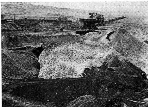
4. Způsob zakládání výsypek. Snímek Vesecký. — Method of laying-out of spoil banks. Photo Vesecký
