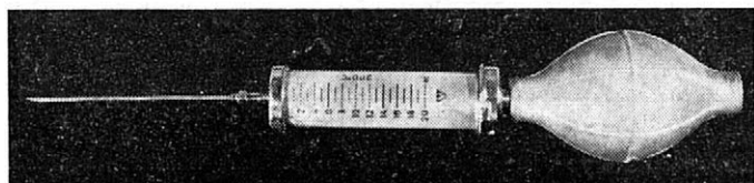
4. Přístroj z balónku a injekční stříkačky o obsahu 20 ccm (modifikace vyvinutá na VÚLHM). — Apparatus made of balloon and syringe, capacity 20 cu. cm (modification developed in the Forestry and Game Research Institute)
