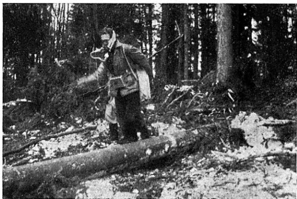
5. Řidič traktoru vynáší lano do porostu. Je vybaven krátko- vlnnou vysílačkou s anté- nou. Polomaskou vydechuje do Douglasova vaku, který má upevněn na zádech
