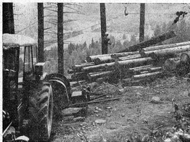
5. Strojník-odpínač řídí dálkově naviják DON při tažení nákladu na skládku
