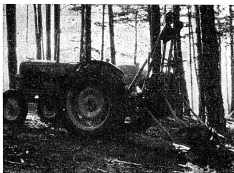
10. Traktor skandinávské výroby s navijákem pro oběžné přibližování slabší kulininy
