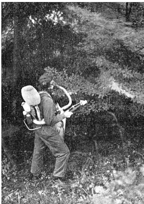
1. Odběr vydýchaného vzduchu do Douglasových vaků při modelové aplikaci přístrojem Solo-Junior. Snímek Vaniš
