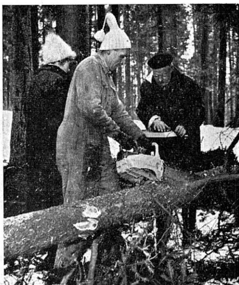
18. Odvětvování pilou Stihl-08 s opíráním pily o kmen
