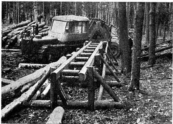
2a — odkorňovací souprava ze strany podávání výřezů, b — odkorňovací souprava ze strany odsouvání odkorněných výřezů
