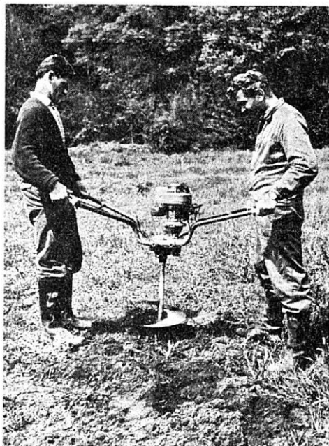
2. Príprava pôdy prenosným jamkovačom.
