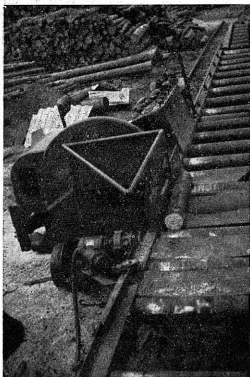
4. Prenosná poloautomatická skracovacia linka podľa zlepšovacieho návrhu inž. T o m a n a.
