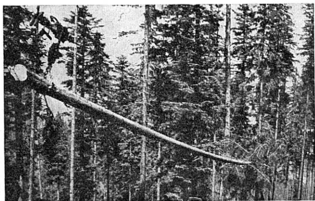
3. Doprava neodvetvených stromov lanovkou DPLu 2-2000
