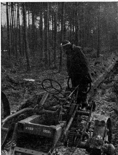
4. Sovětský pluh PP-50 při orbě degradované lesní půdy
