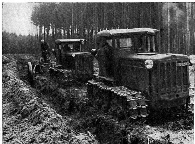
5. Meliorační orba degradované lesní půdy se stmelenec. Předcházelo vyklučení kmenů. Po-třebný S-80 (S-100) nebyl k dispozici
