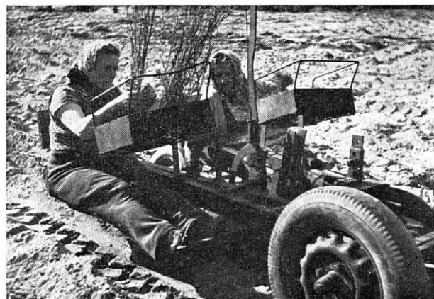
7. Mechanizovaná sadba lesní kultury na půdě po celoplošné meliorační kultivaci (sázecí stroj Riedl)
