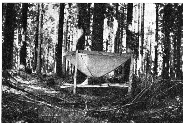
3. Typ opadové nálevky ze silonového tkaniva (velikost 1 × 1 m), jíž byly zachycovány housenice ploskohřbetky při opadu z korun. Housenice propadávají na dně nálevky otvorem do krabice s hrabankou, kde se shromažďují.
