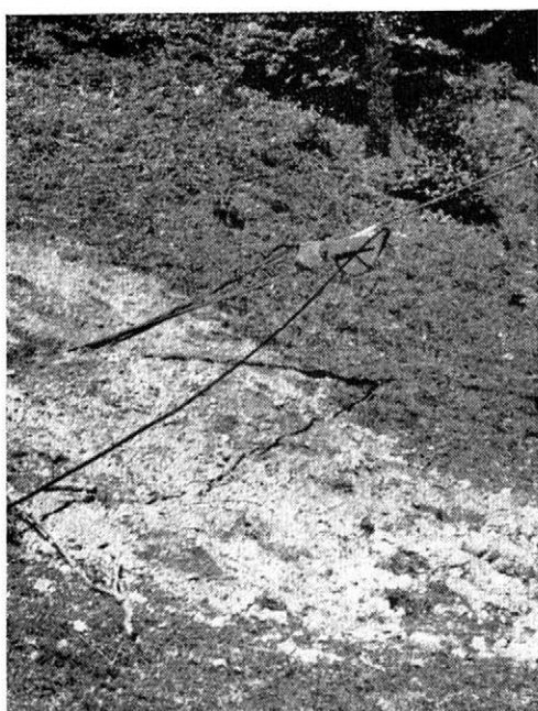
12. Zakotvení vyklizovací lanovky na klídu zakopanou v zemi.
