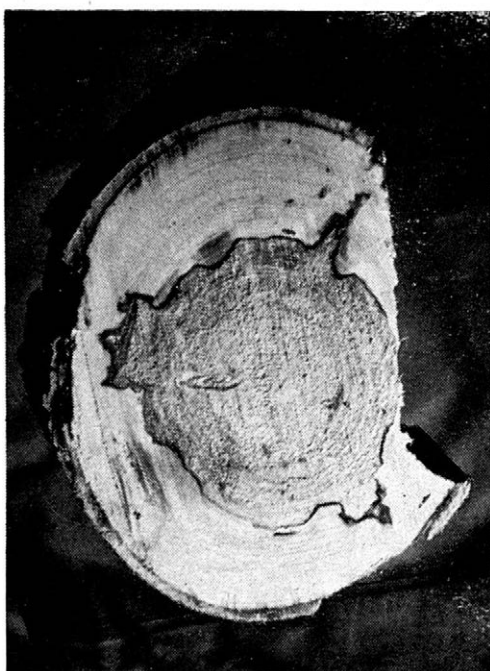
Obr. 3d. Úřez ve výšce 3 m. Silnější rozrušení dřeva s náznakem černé linie
