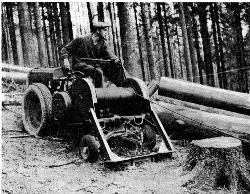
Obr. 6. Jednobubnový pojízdný naviják s převodovou skříní namontovaný na Motorobotu. (Konstrukce VS Křtiny). Zadní bantamová kolečka jsou říditelná
