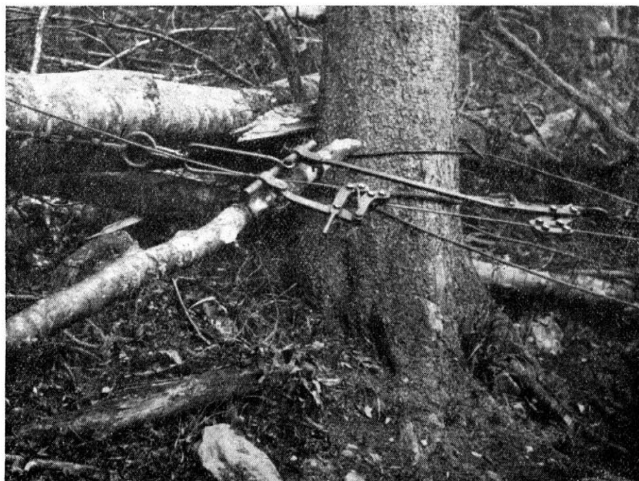
Obr. 3. Lesní »čert« při napínání nosného lana pomocným lanem. Pohybem páky zabírají jednotlivé čelisti
