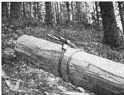
Obr. 6. Správně zapnutý úvazek umožňuje bezpečný a bezporuchový provoz při vyklízování. Foto Jos. Řičný.
