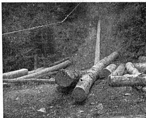
Obr. 1. Přibližování výřezů dvoububnovým navijákem prostým vlečením po svahu. Kmen je lanovým úvazkem přichycen k pohyblivé úchytkce.
