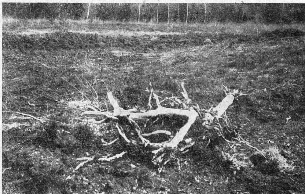
Fotografie č. 2. Při těžbě rašelin je nutno zachovalé kořeny stromů, pohřbené v ložisku, odstranit. Foto Dr. Spirhanzl.
