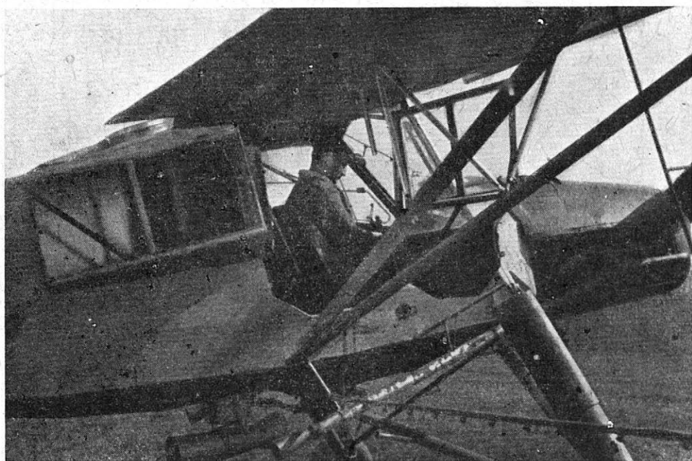
Obr. č. 1. Technická úprava na letadle a zařízení pro rozmlžení aerosolních látek různými způsoby (přehřátím v prodloužených výfucích od motorů, rozptylem po výtoku z nádrže do Venturiho trubice). Dlouhá ráhna s dýznami pod křídly je zařízení pro postřik. — A. Celkový pohled, B. Detail. (Foto Ing. Zapletal.)
